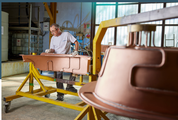
Pièce en cuivre pour accélérateur de particules Dimensions : 1200*1100*350 mm Masse : 70 Kg Dépôt : cuivre, jusqu'à 10 mm selon les zones
